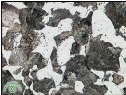
Stahl mit ca. 0,40 % Kohlenstoff Gefüge besteht zu ca. 50 % aus Ferrit und zu 50 % aus Perlit
