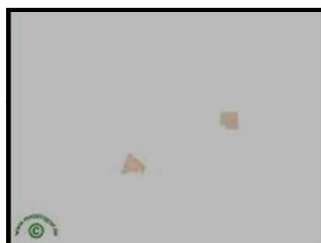
Titankarbide (Titanocarbonitride) sind an der Orangen Farbe zu erkennen.
