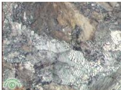
Stahl mit ca. 0,80 % Kohlenstoff. Gefüge aus Lamellarem Perlit und Sorbit (feinlamellarer Perlit). Aufgrund des relativ hohen Kohlenstoffgehaltes ist kein Ferrit vorhanden.
