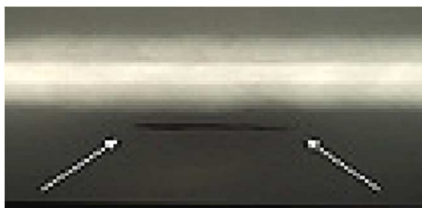
Riss in der Wärmeeinflusszone einer Schweißnaht.
